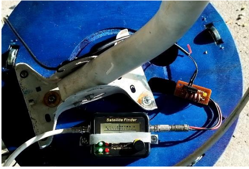
Deflexion de la aguja debido a la radioemisión solar.
